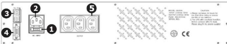
1. Входной предохранитель
