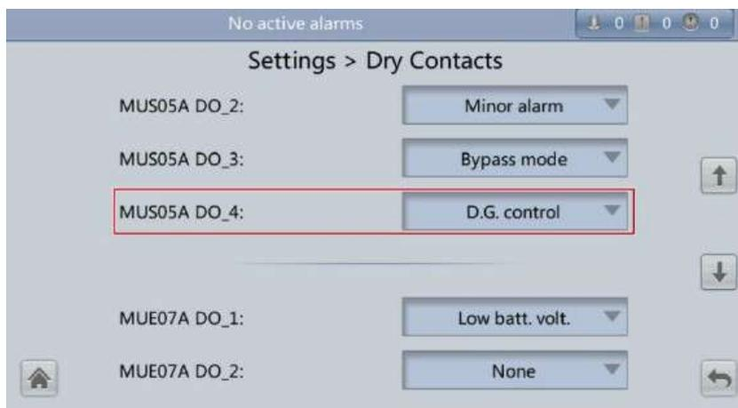
Рисунок 4-53 Сопутствующие параметры интеллектуального энергообеспечения на ЖК-экране 6
