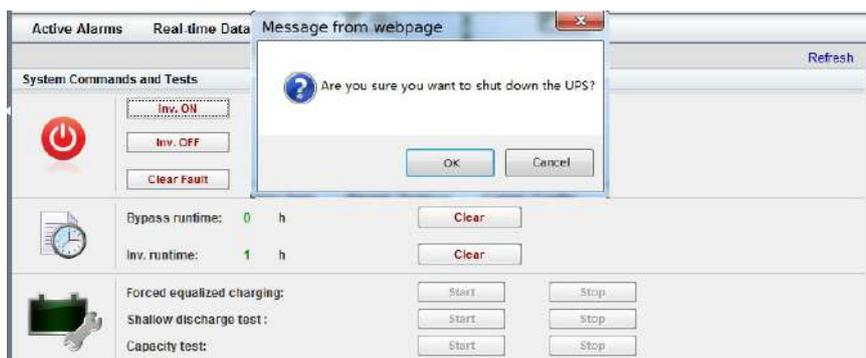
Шаг 2. После выключения инвертора, если байпас нормальный, ИБП переходит в режим байпаса; Если байпас неисправный, ИБП прекращает подачу питания, нагрузки отключаются, как показано на Рисунках 4-16 и 4-17.
