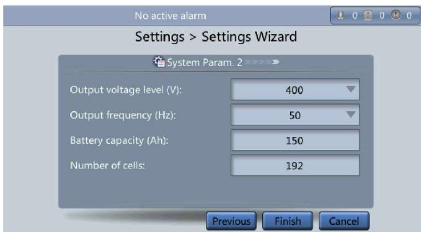
Шаг 3. Если после указания параметров на экране мастера настройки на странице мониторинга не будет отображаться ни одного исключительного аварийного сигнала, выполните следующие действия. Если на странице мониторинга отображаются исключительные аварийные сигналы, удалите все аварийные сигналы.
